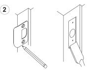
Haga un vaciado en el centro de la perforación marcada anteriormente. Remarque el contorno del contrafrontal y realice un rebaje en el área demarcada para permitir que el contrafrontal quede al ras de la superficie.
