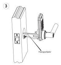
Desmonte el paquete que contiene el panel exterior. Tenga cuidado de no rayar o dañar el tablero del circuito (color verde) durante la manipulación e instalación.
