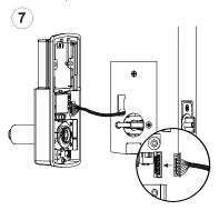
Conecte el cable en la placa interior. El enchufe del cable tiene una posición única de montaje. El cable tiene una línea y el conector de la placa también. Las líneas en el enchufe y el conector deben estar en la misma dirección.
