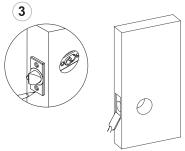
Monte el cuerpo cerrojo en el agujero del canto de la puerta y trace el contorno del frontal de la cerradura sobre el canto de la puerta usando un lápiz. Realice un rebaje en el área demarcada utilizando un formón, lo suficientemente profundo para dejar el frontal de la cerradura al ras de la puerta cuando esta se monte en la perforación.
