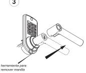
Tome el panel exterior y gire el cilindro hacia la posición de apertura.
