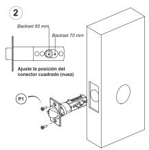
Ajuste la posición del conector cuadrado (nuez), según el backset elegido, deslizando el conector (nuez) a la posición deseada.
