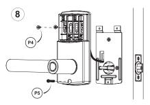
Monte el panel interior sobre el transportador. Haga coincidir el panel con el transportador y deslícelo hacia la puerta
