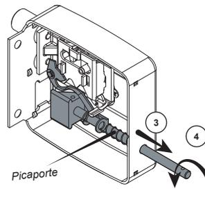
Vuelva a montar el tirador en el vástago y fíjelo con el tornillo. Dirija el picaporte hacia el vaciado de la caja. Monte la tapa y fijela con el tornillo para terminar la operación.
