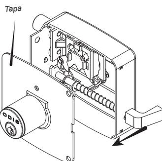
Desmonte el tornillo del tirador (1) y retire el tirador del vástago (2).
