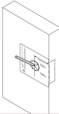
Realice una perforación en el centro previamente marcado de 30mm de diámetro. Luego, realice un rebaje de 3mm en la en contorno delineado de la pestaña de cerradura
