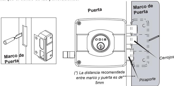
Monte el contrafrontal de manera que las perforaciones que incluye puedan recibir el picaporte y los cerrojos y fíjelo con los tornillos. Para facilitar el montaje de los tornillos, perforo previamente con una broca (ø2,5mm) en el centro de las perforaciones previamente marcadas.
