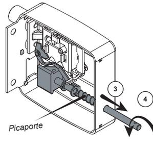
Vuelva a montar el tirador en el vástago y fíjelo con el tornillo. Dirija el picaporte hacia el vaciado de la caja.
